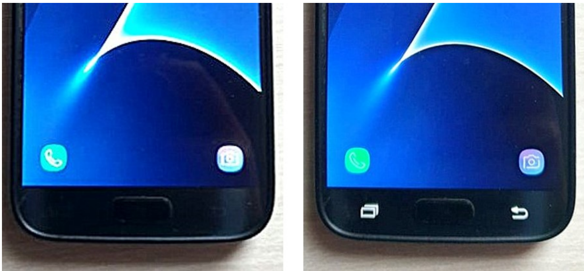
Slika 5. Primjer uređaja s osvjetljenom strelicom (desno) za vraćanje unatrag. Dodirom na taj dio površine uređaja, uključuje se LED-lampica koja osvjetli tipku i učini ju vidljivijom.
