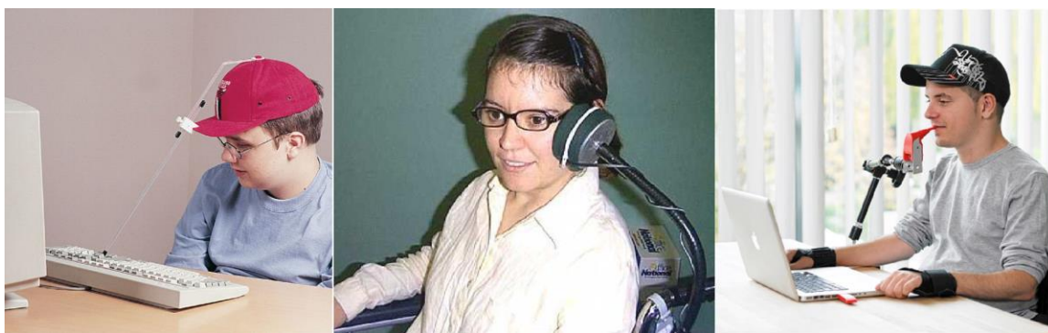
Slika 1: prikaz pomoćnih tehnologija: head wand , single switch i sip-and-puff switch
