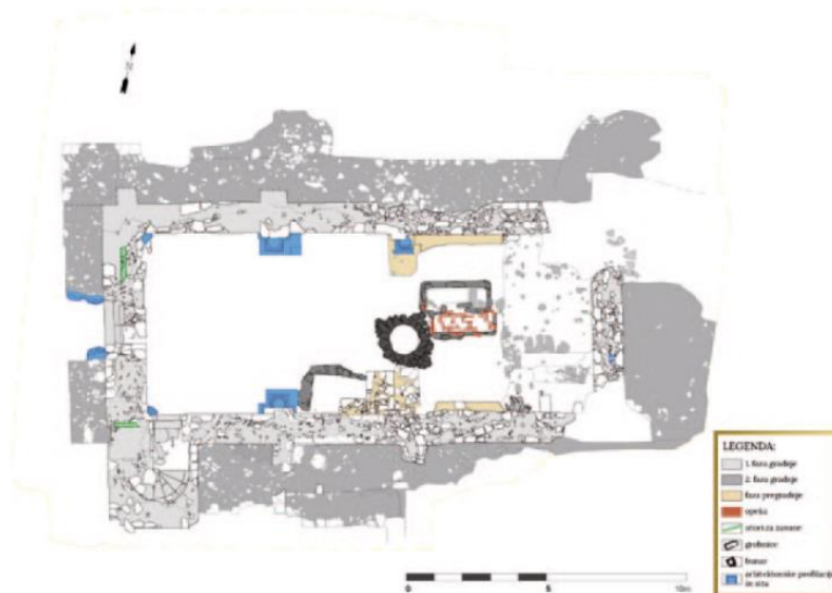
Slika 5 tlocrt kapele u Pakracu s fazama gradnje (Belaj 2021, 225.)
