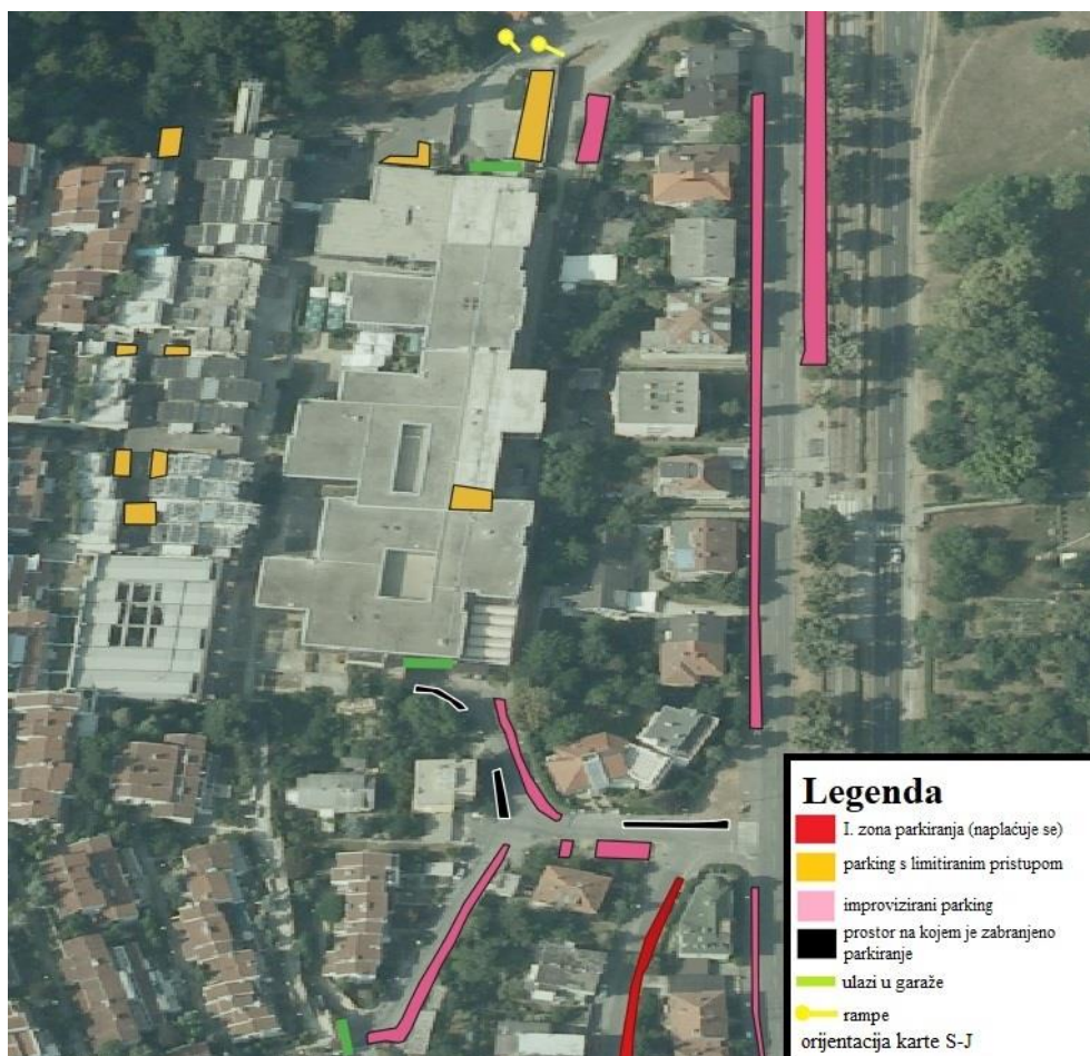
Karta 2. s legendom, stanje parkinga na istočnoj strani naselja Ksaver (autorska karta na podlozi preuzetoj s DGU: https://geoportal.dgu.hr/ )
